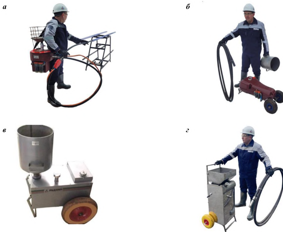
Рис.1. Зарядчики шпуровые: а) РХ-1; б) РХ-2.001.1 ; в) РХ-2-001.2; г) РХ-2.002
