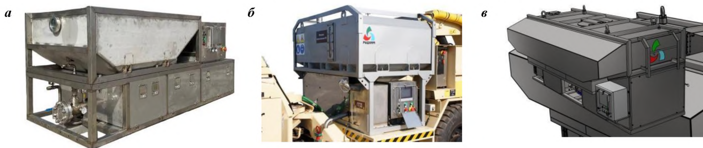
Рис. 2. Транспортируемые смесительно-зарядные модули
